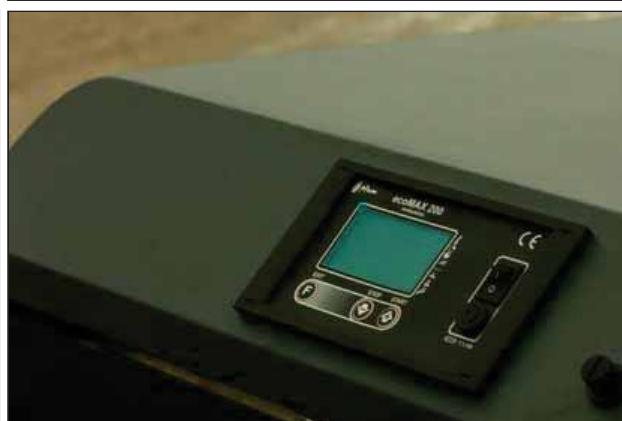
Smart elektronisk styrning med modulering av fläkten och rökgasstyrning.
