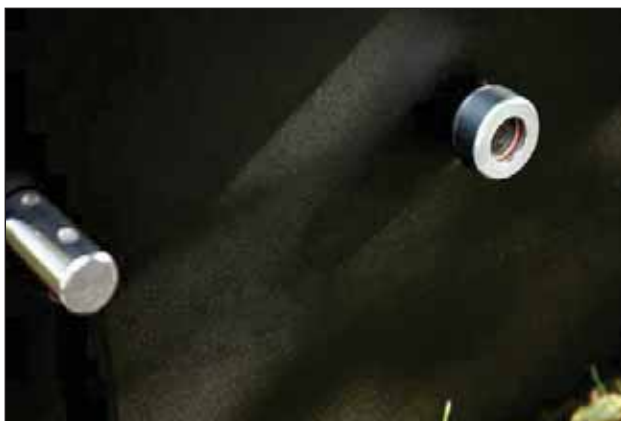
Siktglas för att kunna övervaka förgasningsprocessen.
