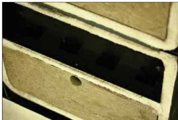
Kanaler för förvärm� förbränningsluft.
